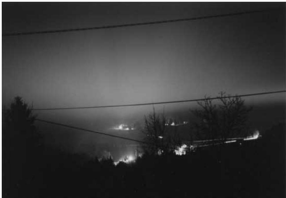
*Slika 5: Nočni posnetek delno zasenčene svetilke CD 116 pred sanacijo (november 2000) iz Astronomskega observatorija (razdalja 1200 m). Zaradi sipanja svetlobe na razpršilnem pokrovu je znaten del svetlobnega toka uhajal poševno (slika 4) in navzgor proti nebu (slika 5). To je povzročalo motnje pri astronomskih opazovanjih. Osvetlitev je trajala 2 minuti, kar je primerljivo z osvetlitvami, ki jih uporabljamo pri snemanjih s CCD kamero na observatoriju.*
